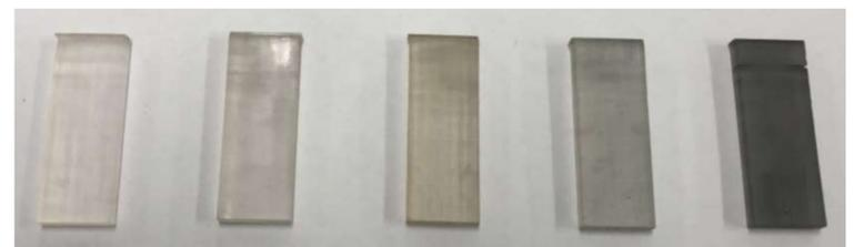
FIGURA 5: amostras impressas em ordem de concentração: resina pura, 0,0025%, 0,0125%, 0,0500% e 0,100%.
